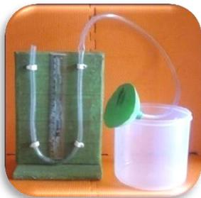
Gambar 1. Alat peraga untuk menyelidiki tekanan di dalam zat cair
